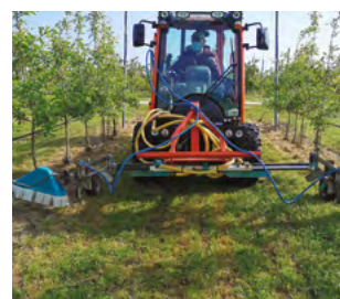
Rampe de désherbage classique avec caches de protection pour la pulvérisation des désherbants
